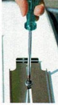
Les tôles de fixation en inox doivent être montées à l'aide de vis aux endroits prévus sur le véhicule. Placez le tampon en caoutchouc entre la tôle de fixation et le pare-chocs.
