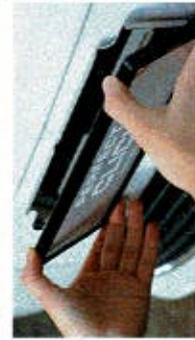
Wechselrahmen von unten nach oben bei den vorstehenden Laschen einführen. Auf seitliche Zentrierung achten. Prüfen, ob Wechselrahmen auf den Halteblechen richtig aufliegt.
