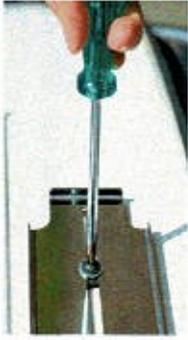
Die rostfreien Haltebleche sind mit Schrauben an die vorgesehenen Stellen an den Fahrzeugen zu montieren. Gummipuffer zwischen Halteblech und Stossstange anbringen.
