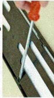
Alle vier Schieber in Endposition bringen. So ist das Kontrollschild im Wechselrahmen sicher befestigt.
